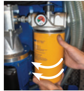
Afb. 6: Losdraaien van filter tegen de klok in.
